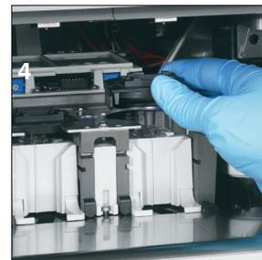
5. Heben Sie die Probenfachanordnung hoch, indem Sie auf die Klinke in der Mitte drücken und sie hochheben.
