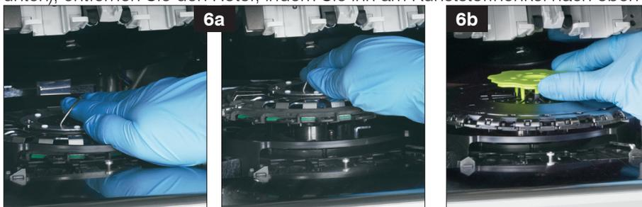
7. Wischen Sie die Führung des Inkubatorrings mit dem von IDEXX empfohlenen Alkoholtupfer gegen den Uhrzeigersinn ab (wischen Sie die optischen Fenster und die Ionenfenster jetzt noch nicht ab). Wiederholen Sie diesen Schritt mindestens dreimal mit jeweils einem neuen Tuch bei jeder Wischbewegung.
