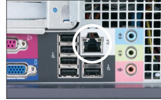
Ethernet-Anschluss auf der Rückplatte des Hauptprozessors (CPU) des Computers der IDEXX VetLab Station
